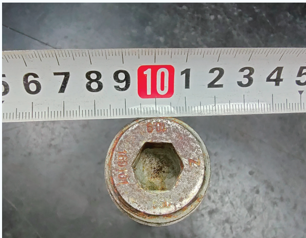
图3 叶根内六角螺栓端面尺寸
