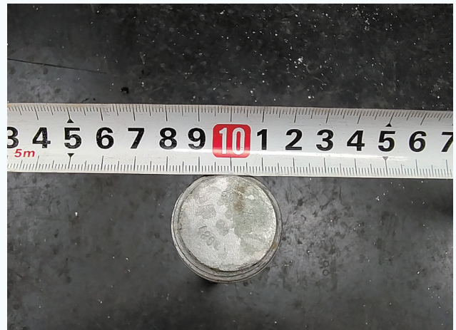
图4 叶根非内六角螺栓端面尺寸
